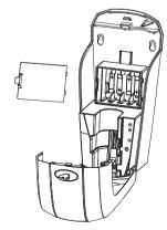
Öffnen Sie das Batteriefach
